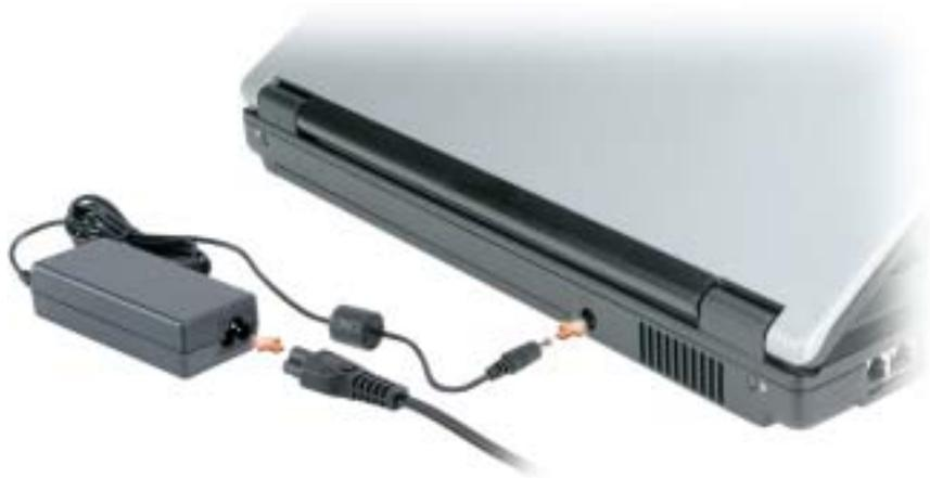
AC アダプタは AC 電力をコンピュータに必要な DC 電力へと変換します。AC アダプタは、コンピュータの電源のオンまたはオフにかかわらず接続できます。
