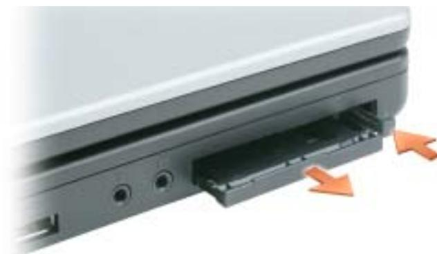
スロットに ExpressCard を取り付けない場合に使用するダミーカードは保管しておきます。ダミーカードは、埃や他の異物から未使用のスロットを保護します。
